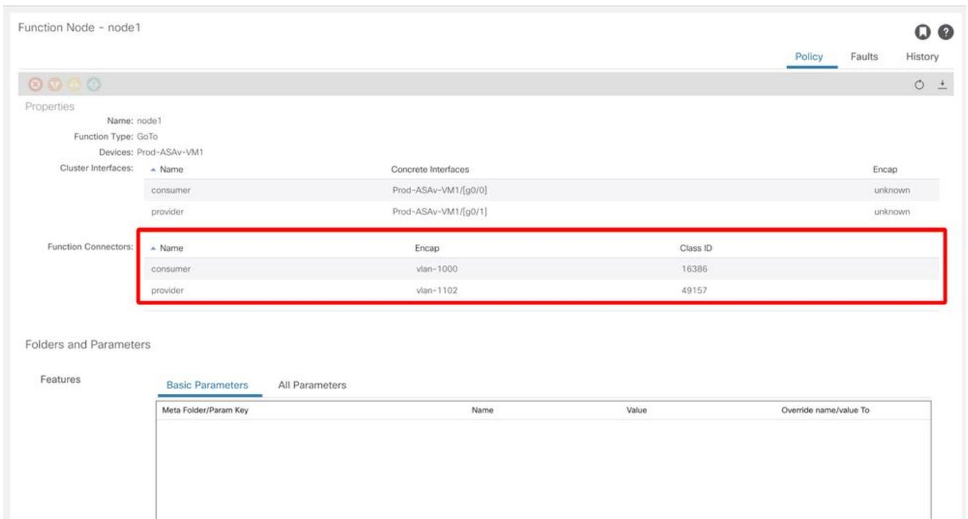
这些VLAN部署在连接服务节点的服务枝叶节点接口上。在服务枝叶节点CLI上使用“show vlan extended”和“show endpoint”可检查VLAN部署和终端学习状态。
