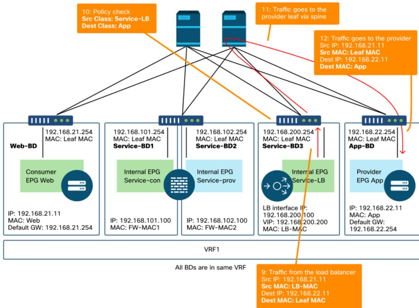
下图显示了从提供商EPG应用到消费者EPG网络的返回流量。由于返回流量发往原始源IP，因此PBR需要使返回流量返回负载均衡器。
