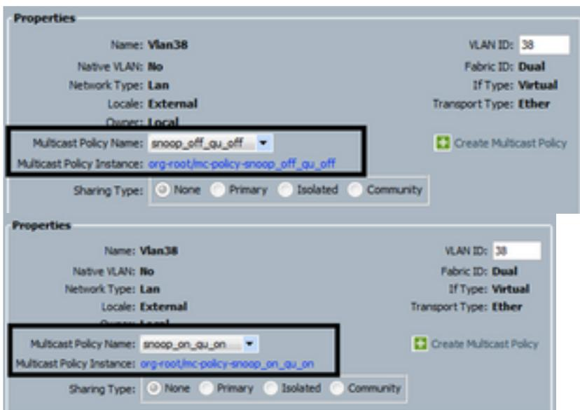
如果创建多个VLAN对象，这些对象指向相同的VLAN ID，则当应用组播策略时，它将应用于具有相同VLAN ID的所有VLAN对象。应用的最新组播策略应用于所有。例如：QMulticast更改为 Snoop\_off\_qu\_off(Vlan 38)。
