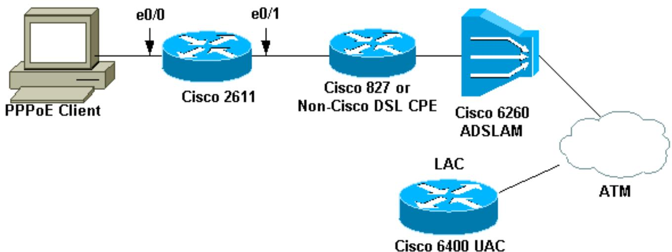
**Note:** 在本文中，PPPoE客户端连接从Cisco路由器首次。这是在此配置的Cisco 2611路由器。Cisco 827路由器在图表中表示非Cisco的DSL CPE。
