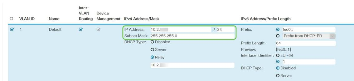
步骤4. (可选) 如果路由器不是分配IP地址的DHCP服务器/设备，则可以使用DHCP中继功能将DHCP请求定向到特定IP地址。IP地址可能是连接到WAN/Internet的路由器。
