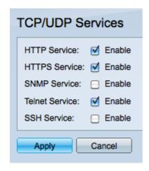
步骤2.选中Enable in the Telnet Service复选框,以通过Telnet启用交换机访问。
