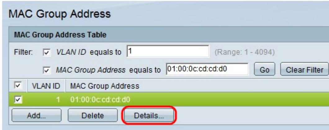
步骤2.单击Details...以配置组内接口的注册。系统将显示“MAC组地址设置”窗口。
