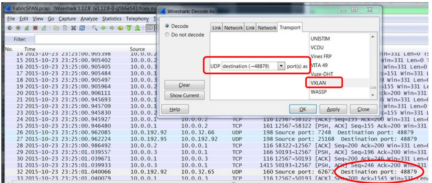
iVxLAN报头使用目的端口48879。因此，如果您在Wireshark上将UDP目标端口48879配置为VxLAN，则可以解码iVxLAN报头和VxLAN。
