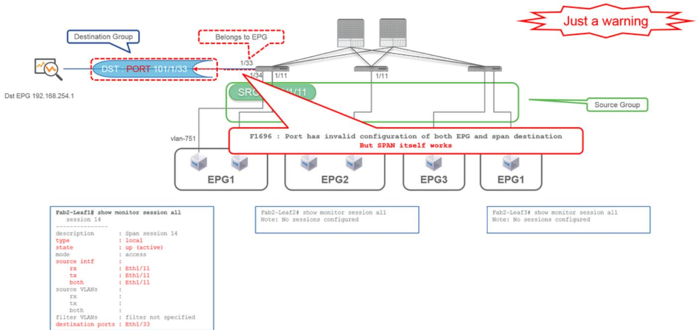
如果SPAN的目标I/F已属于EPG，则在物理I/F下会出现“F1696：端口的EPG和SPAN目标配置无效”故障。
