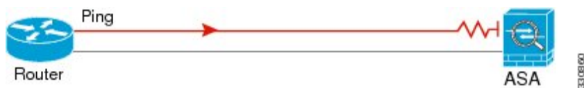
图 4: ASA 没有返回路由引发的 ping 故障
