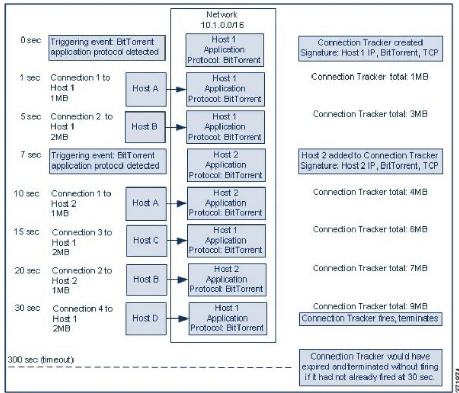
在本示例中，系统在两个不同的主机上检测到 BitTorrent TCP 应用协议：Host 1 和 Host 2。这两台主机通过 BitTorrent 将数据传输到其他四台主机：Host A、Host B、Host C 和 Host D。
