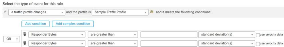
要创建在通过网络的字节数超过一定数量的高于平均值的标准偏差时触发的规则，请仅使用图中所示的第一个条件。
