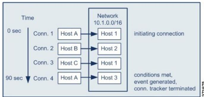
在本示例中，系统检测到满足关联规则基本条件的连接，即系统检测到从 10.1.0.0/16 网络外的主机到该网络内主机的连接。这样创建连接跟踪器。
