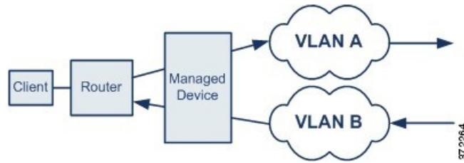
您可以将系统配置为忽略 VLAN 报头，从而可以针对您的部署正确处理数据包。
