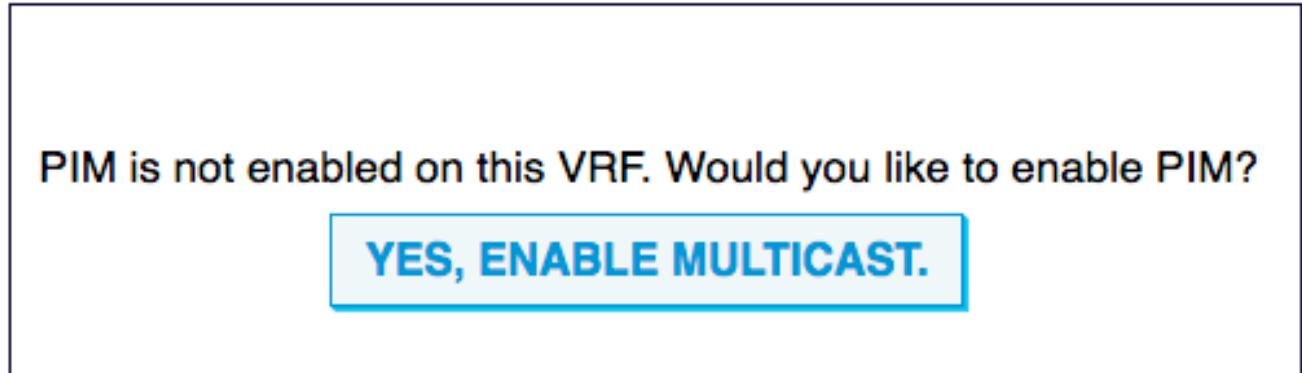
**第2步：**在BD和L3out級別啟用組播，為接收方BD啟用IGMP。導航到Networking > VRFs > VRF name > Multicast，在工作面板上，選擇Configuration > Interface頁籤，按一下「+」以新增需要組播流量的網橋域。為啟用組播的BD啟用IGMP策略。
