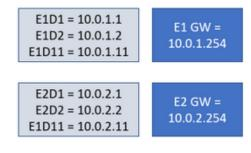
我們的交換矩陣包含兩個終端組(EPG):EPG-1和EPG-2。每個EPG都連結到其自己的網橋域(BD)。
