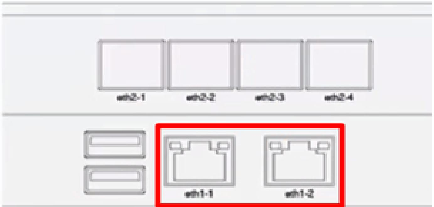
共用LOM具有主用/備用模式和主用/主用模式。可以在CIMC GUI - Admin > Networking > Network (tab) > NIC Properties (section) 部分進行更改。作用中連線埠和待命連線埠均可接收封包，但只有作用中連線埠可以傳送封包。
