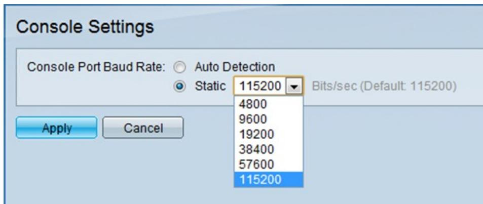
步驟2.在 *Console Port Baud Rate* 欄位中，按一下所需的單選按鈕以配置控制檯埠的波特率。控制檯埠用於配置Sx500系列堆疊式交換機的設定。波特率是每秒通過介質傳輸的位數。
