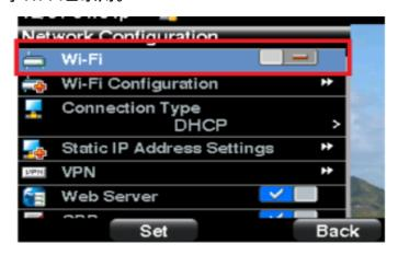
步驟3c(可選)。 選擇Wi-Fi線路後,按向右或向左箭頭鍵,該按鍵將更改為顯示複選標籤。 此圖顯示已啟用Wi-fi。
