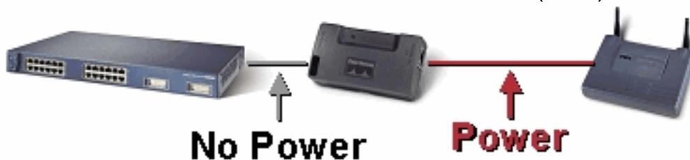
註：線內電源支援的最大距離為100米(m)。對於通過5類電纜連線的每個乙太網連線，此距離都相同。
