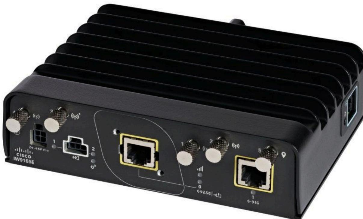
有4個RP-SMA埠用於天線。根據要求，IW9165E可以安裝全向天線、定向天線或兩者的組合。
