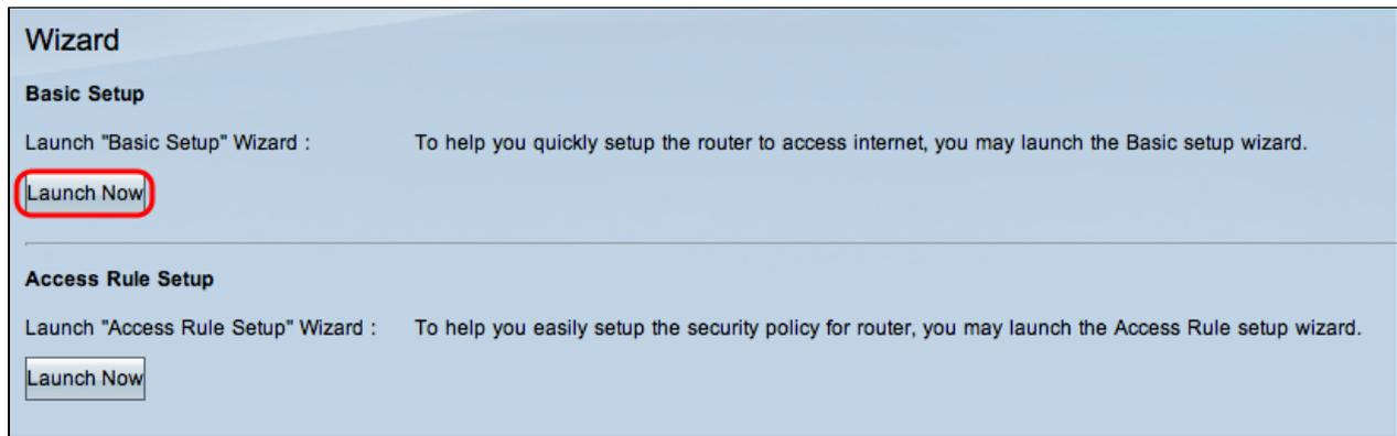
Schritt 1: Klicken Sie im Bereich Basic Setup (Grundeinrichtung) auf **Launch Now (Jetzt starten)**, um den Assistenten für die Grundeinrichtung auszuführen. Das Fenster *Assistent für die Standardinstallation* wird angezeigt.
