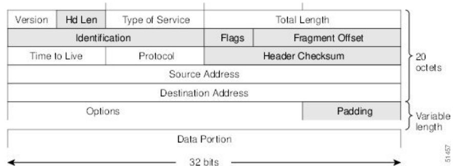
図 8: IPv4 パケット ヘッダー形式
