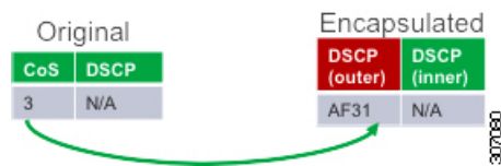
図 33: レイヤ 2 フレームから VXLAN 外部ヘッダーへの優先順位のコピー
