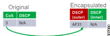
図 37: レイヤ 2 フレームから VXLAN 外部ヘッダーへの優先順位のコピー
