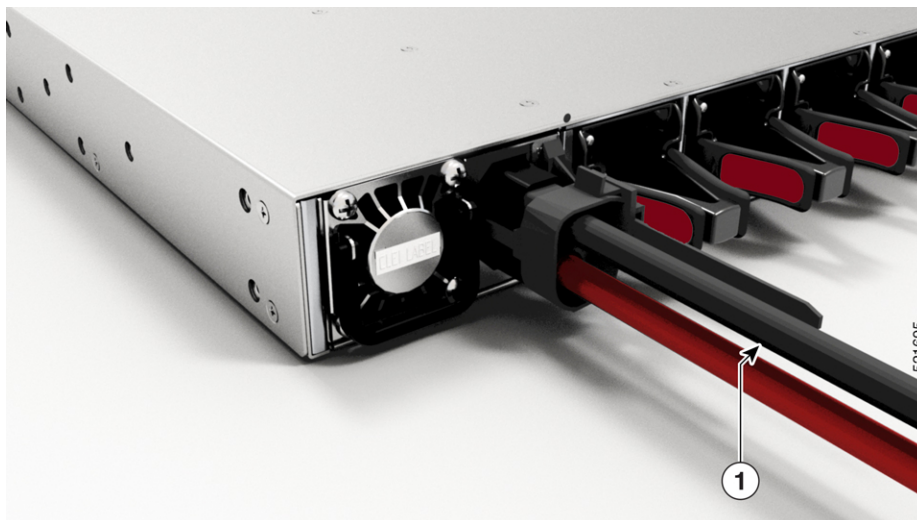
図 15: DC 電源の接続 : Cisco 8111-32EH-0
