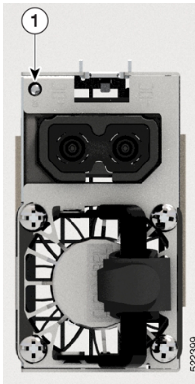
図 13: 電源 LED : Cisco 8202-32FH -M シャーシ
