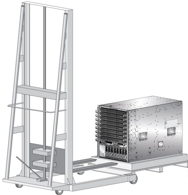
図 15: リフト装置をパレット上のシャーシの前に配置
