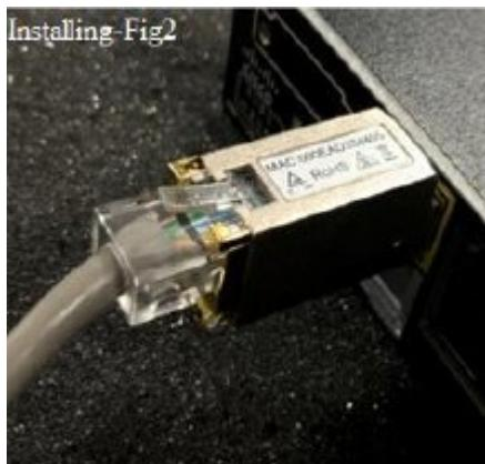
物理的な接続を確認します。ケーブルを差し込むとすぐに LED 2 がゆっくりと緑色に点滅します。
