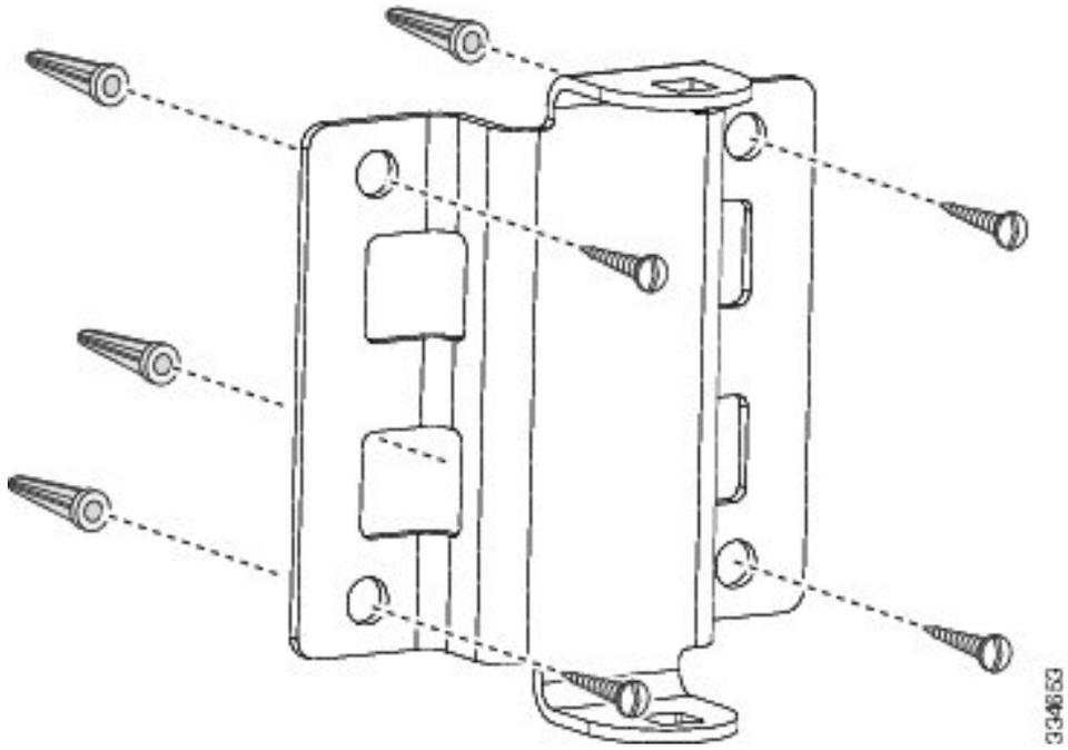
図 10: ブラケット取り付け穴の間隔
