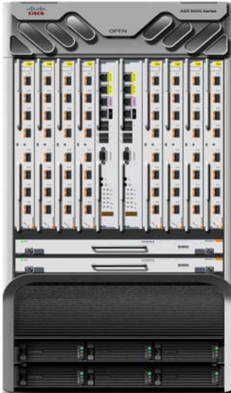
各タイプのシャーシは、スロットあたり 40G をサポートし、入れ替え可能なルートスイッチプロセッサ (RSP) とラインカード (LC) を共有できます。各シャーシでは、2 つのスロットが RSP 用に指定されており、残りのスロットはトラフィックを伝送するラインカードを格納します。RSP はラインカードに相互接続され、シャーシの管理および制御を提供します。すべてのラインカードは、ネットワーク側トランク カードまたは加入者側カードとして使用できるだけでなく、任意の接続形態で使用できます。
