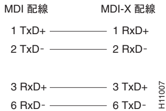
図 1-23 ハブ、リピータ、またはスイッチへのストレート ケーブルのピン割り当て
