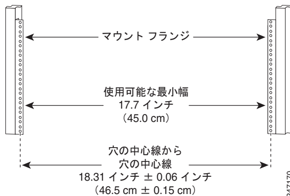
図 2-2 機器ラックの寸法の確認
