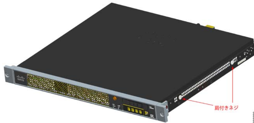
図 3-7 シャーシのいずれかの側への2本の肩付きネジの取り付け
