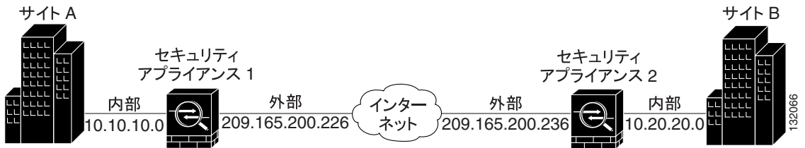
図 8-1 サイトツーサイト VPN の設定シナリオのネットワーク レイアウト
