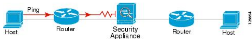
図 83: ASA のアドレス変換の問題による ping の失敗
