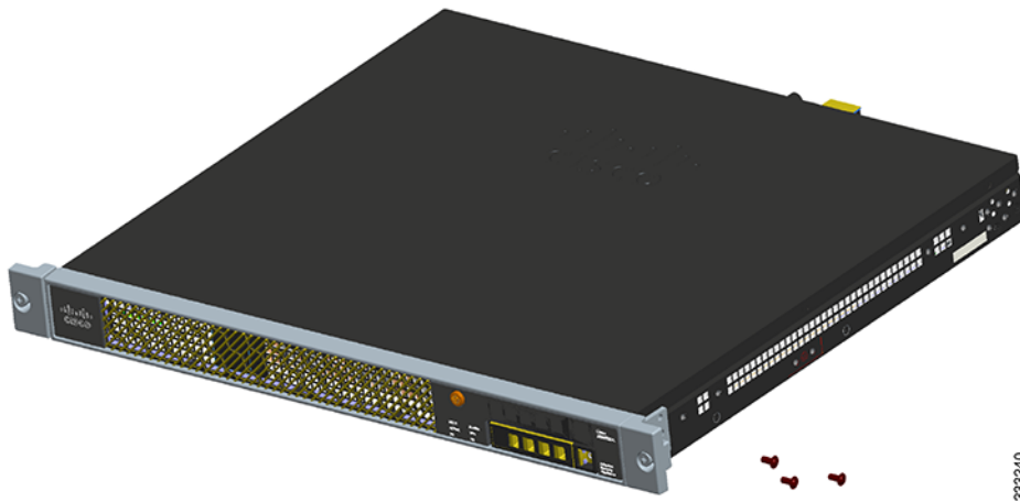
図 6 3本のネジを使用したダイカストブラケットの取り付け
