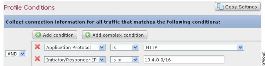
一方、次のトラフィックプロファイルでは、2つのサブネットのいずれかのHTTPアクティビティに関する接続データを収集しますが、最後は複合条件を構成しています。
