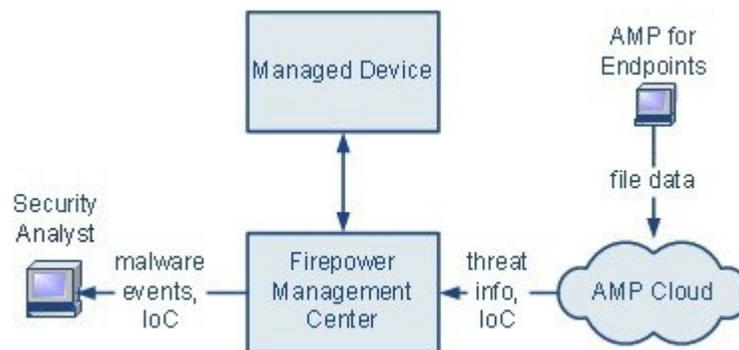
所属部門がエンドポイント向け AMP を使用している場合、個々のユーザはエンドポイント（つまり、コンピュータやモバイルデバイス）に軽量コネクタをインストールします。コネクタは、ファイルのアップロード、ダウンロード、実行、開く、コピー、移動などの操作を行う際にファイルを検査します。コネクタは AMP クラウドと通信して、検査対象のファイルにマルウェアが含まれるかどうかを判断します。
