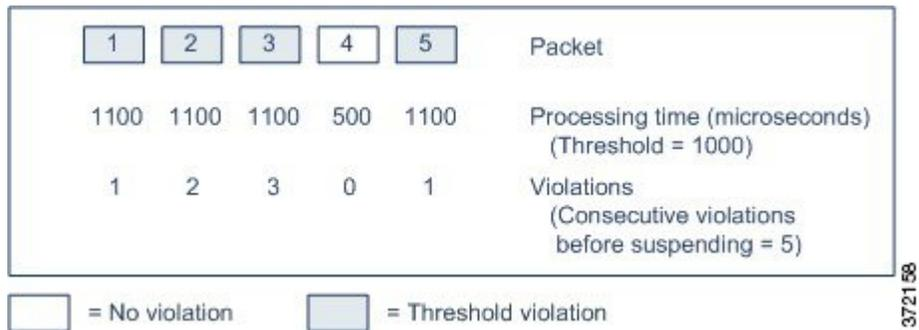
上の例で、最初の3個の各パケットの処理に必要な時間は1000マイクロ秒というルール遅延しきい値に違反し、違反カウンタは各違反のたびに増加します。4個目のパケット処理はしきい値に違反しないので、違反カウンタはゼロにリセットされます。5個目のパケットはしきい値に違反し、違反カウンタは1から再開します。
