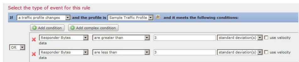
移動するバイト数が、平均を基準とした特定数の標準偏差の上側を超えた場合にトリガーとして使用されるルールを作成するには、以下の図に示されている最初の条件だけを使用します。
