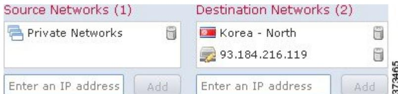
この例で、「Private Networks」と呼ばれるネットワーク オブジェクトグループ (図に示されていない IPv4 および IPv6 プライベート ネットワークのネットワーク オブジェクトから構成されます) は、内部ネットワークを表します。また、example.com の IP アドレスを手動で指定し、システムが提供する北朝鮮の地理位置情報オブジェクトを使用して北朝鮮の IP アドレスを表しています。
