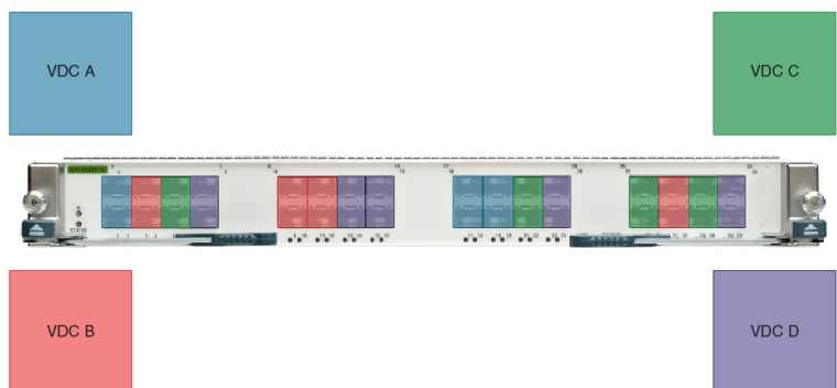
図 4: Cisco 7000 シリーズ 10 Gbps イーサネット モジュール (N7K-F132XP-15) のポートグループでのインターフェイスの割り当て例
