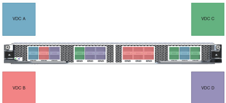
図 8: Cisco Nexus 7700 シリーズ 24 ポート、40 Gbps イーサネット モジュール N77-F324QF-25
