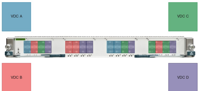
図 15: Cisco 7000 シリーズ 10 Gbps イーサネット モジュール (N7K-F132XP-15) のポートグループでのインターフェイスの割り当て例
