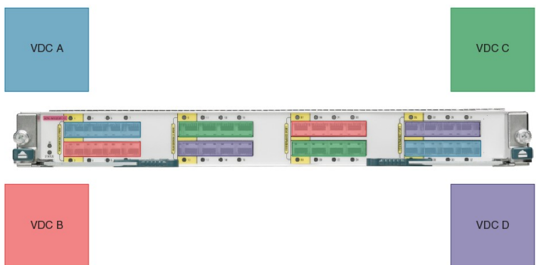
図 3 : Cisco 7000 シリーズ 10 Gbps イーサネット モジュール (N7K-M132XP-12) のポートグループでのインターフェイスの割り当て例
