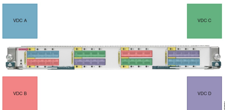
図 14 : Cisco 7000 シリーズ 10 Gbps イーサネット モジュール (N7K-M132XP-12) のポート グループでのインターフェイスの割り当て例
