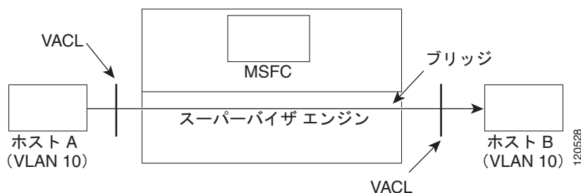
図 32-1 ブリッジド パケットへの VACL の適用
