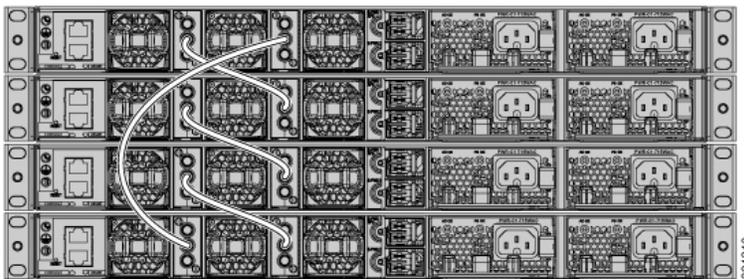
次の例は、スイッチを横に並べて設置する場合の推奨構成です。1 m および 3 m の StackWise ケーブルを使用してスイッチを接続します。この構成で冗長接続機能が可能になります。
