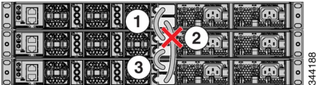
次の図では、センタースイッチの StackPower ポート B が故障しており、このスタックが 2 つのスタックに分かれています。上部の 2 台のスイッチは電力を共有し、下部のスイッチは別スタックになっています。ケーブル 2 の初期障害の後、ポートのそれ以上の障害は二重障害と見なされ、StackPower は処理できません。二重障害が発生すると、高優先順位ポートが意図せずシャットダウンされる可能性があります。不良ケーブルを物理的に復元できない場合は、ポートの優先順位を調整し、可能な場合はオフラインの電源を復元します。
