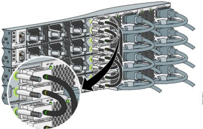
次の図に、スタートポロジで接続した 8 個のスイッチを示します。
