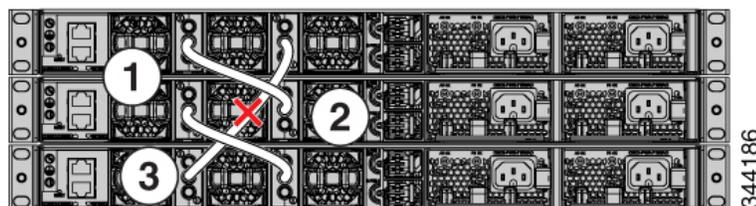
次の図では、リンク 2 が不良です。したがって、このスタックは 2 つのスタックに分離し、最上部と最下部のスイッチがこのスタックの中でアクティブ スイッチになります。最下部のスイッチがメンバー（アクティブ スイッチでもなく、スタンバイ スイッチでもないスイッチ）の場合、このスイッチはリロードされます。
