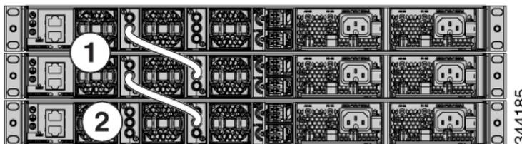
以下の図はいずれも、フェールオーバー状態のスイッチのデータ スタックを示します。次の図では、リンク 2 の StackWise ケーブルが不良です。したがって、このスタック構成では帯域幅を半分しか使用できず、接続の冗長性も確保されません。
