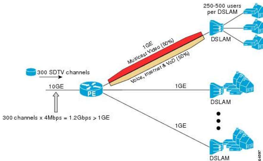
この例では、サービスプロバイダは、300 の標準画質（SD）TV チャンネルを提供しています。各 SD チャンネルが、約 4 Mbps を使用します。
