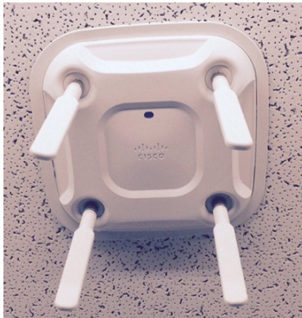
図 9-2 アンテナが同じ方向に(正しく)向けられた AP
