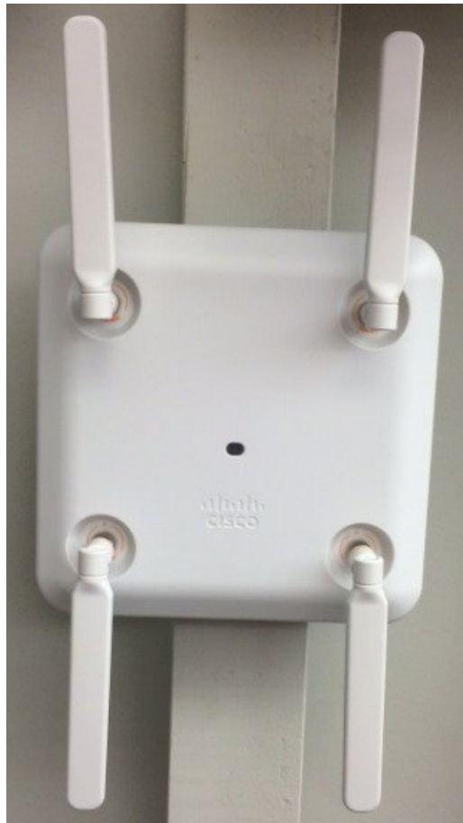
図 19: 垂直面に取り付ける場合のダイポール アンテナの正しい向き
