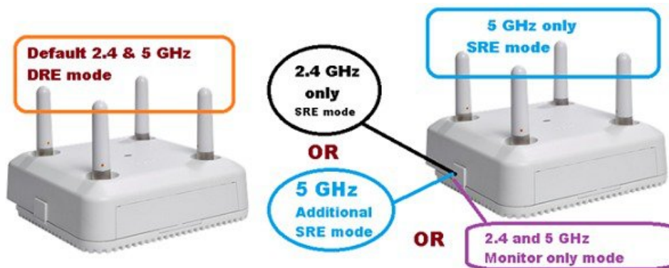
図 36: アンテナ制御 (デフォルト) とスマートアンテナコネクタの設置
