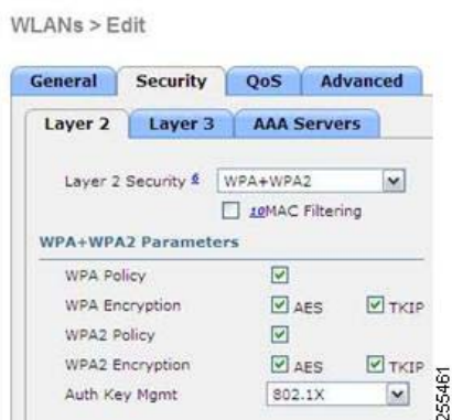
図 8-24 OEAP シリーズに対する互換性のあるセキュリティ設定
