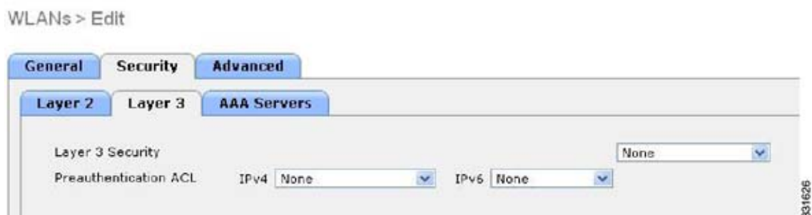
図 8-31 リモート LAN の OEAP 600 シリーズ AP に対するレイヤ 3 セキュリティ設定
