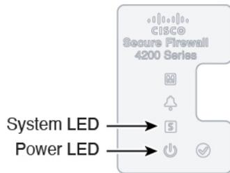
**단계 4** 방화벽 뒷면의 시스템 LED를 확인합니다. 시스템이 전원 커기 진단을 통과하면 녹색으로 표시됩니다.
