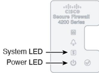
단계 4 방화벽 뒷면의 시스템 LED를 확인합니다. 시스템이 전원 켜기 진단을 통과하면 녹색으로 표시됩니다.
