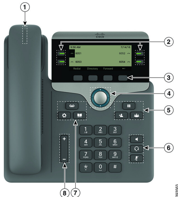
Figuur 6: Toetsen en functies van de Cisco IP-telefoon 7800-serie
