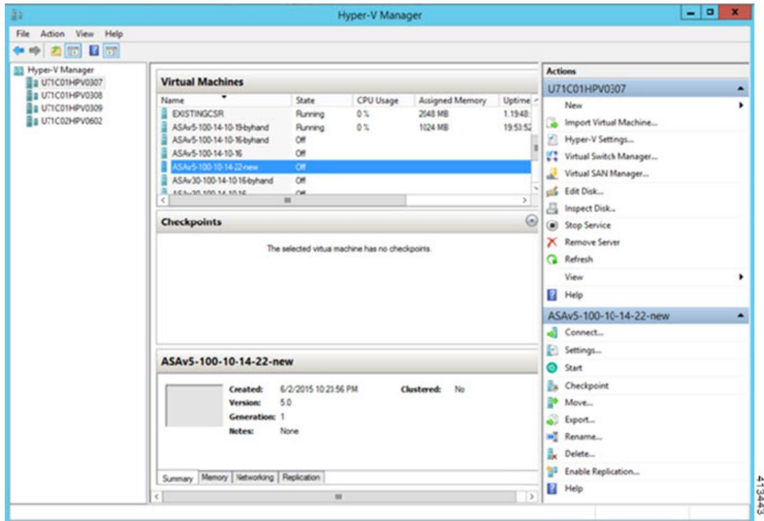
步骤 3 从右侧的虚拟机监控程序列表中，右键单击列表中的所需虚拟机监控程序，然后选择 **New > Virtual Machine**。
