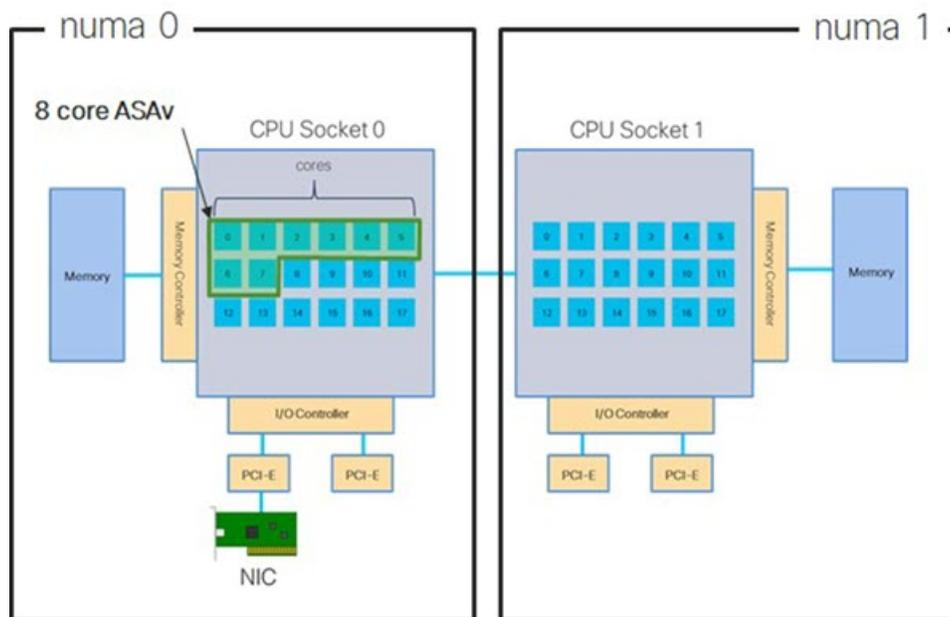
下图显示的服务器有两个 CPU 插槽，每个 CPU 有 18 个内核。16 核 ASAv 要求主机 CPU 上的每个插槽至少有 16 个内核。
