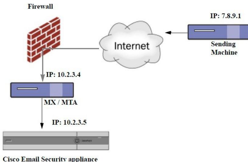
下图显示了另外两个稍微复杂一些的示例，展示了如何在网络内中继邮件以及邮件在传递到邮件网关之前如何通过网络内的多台服务器处理邮件。在示例 A 中，来自 7.8.9.1 的邮件穿过防火墙并在传送到邮件网关之前通过 MX 和 MTA 来处理。在示例 B 中，来自 7.8.9.1 的邮件发送到负载均衡器或其他类型的流量整形设备，然后在传送到邮件网关之前发送到任意一个 MX。
