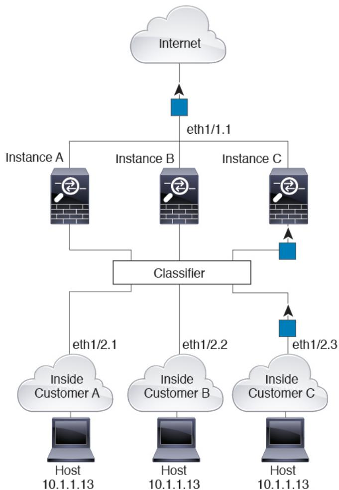
对于透明防火墙，您必须使用唯一接口。下图展示了来自互联网并以实例 C 内部网络上的主机为目标的数据包。由于传入接口是分配至实例 C 的以太网接口 1/2.3，因此分类器会将数据包分配至实例 C。
