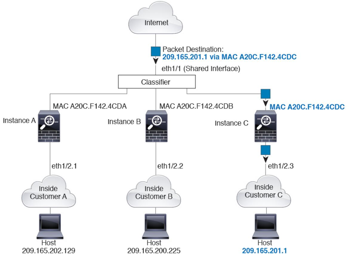
请注意，必须对所有新的传入流量加以分类，即使其来自内部网络。下图展示了实例 C 内部网络上的主机访问互联网。由于传入接口是分配至实例 C 的以太网接口 1/2.3，因此分类器会将数据包分配至实例 C。
