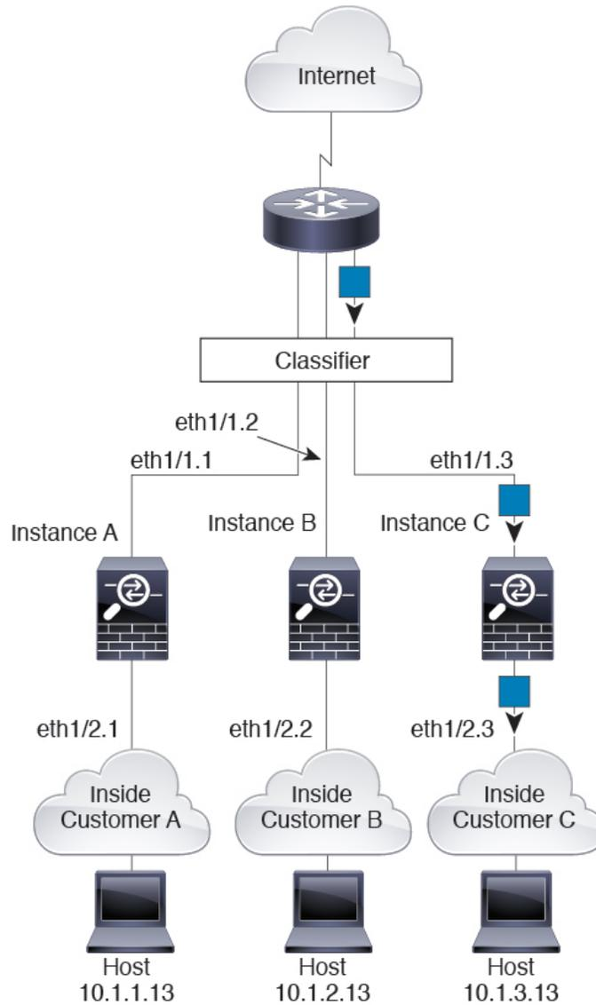
对于内联集，必须使用唯一接口，并且这些接口必须为物理接口或 Etherchannel 接口。下图展示了来自互联网并以实例 C 内部网络上的主机为目标的数据包。由于传入接口是分配至实例 C 的以太网接口 1/5，因此分类器会将数据包分配至实例 C。
