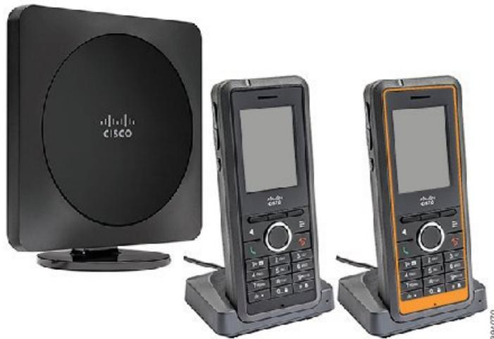
听筒电话使用数字增强无绳通信 (DECT) 与基站通信以提供呼叫功能。听筒必须位于基站的范围内才能正常工作。当听筒超出基站的范围时，您会收到一则告警，您需要在呼叫功能范围内移动。
