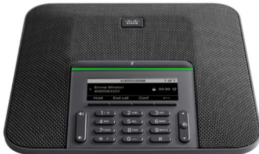
电话配有支持 360 度全方位覆盖的敏感麦克风。这样的覆盖范围可确保当以正常语音讲话的使用者和倾听者相距达 7 英尺（2.1 米）时，倾听者仍可以听到使用者讲话。此电话还采用抵抗移动电话和其他无线设备干扰的技术，从而确保通信可以清晰无干扰地传达。
