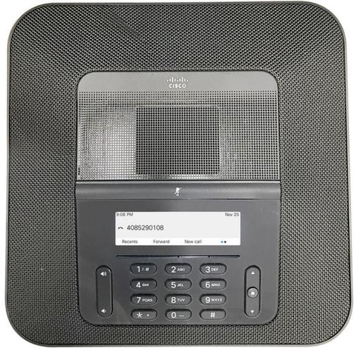
会议电话上拥有 360 度全方位覆盖的敏感麦克风。这样的覆盖范围可确保即使您以正常音量说话，10 英尺（3 米）开外的地方也能清楚听到。此电话还采用抵抗移动电话和其他无线设备干扰的技术，确保通信可以清晰无干扰地传达。此电话配备有用于访问用户功能的彩色屏幕和软键按键。如果仅使用基本设备，这款电话可覆盖 20 x 20 英尺（6.1 x 6.1 米）的会议室，最多供 10 人使用。
