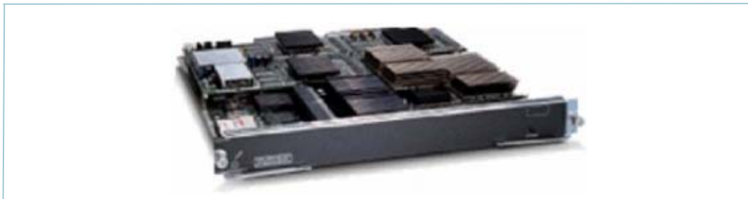
图 4 用于 Cisco Catalyst 6500 系列交换机和 Cisco 7600 系列路由器的 Cisco FWSM
