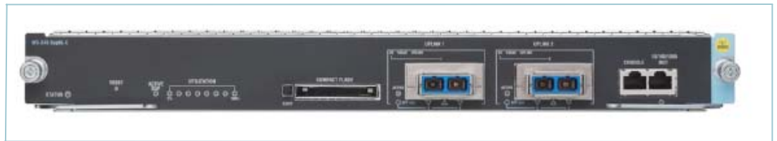
图 1. 支持 TwinGig（2 个万兆以太网或者 4 个千兆以太网）的基本第三层交换 Supervisor Engine 6L-E
